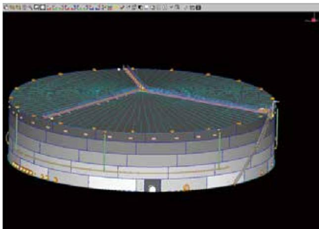
它能够对地面储罐（无论是车间焊制，还是现场焊制）进行快速搭建、设计，以及详细的结构设计。设计规范包括 API650、API620、AWWA 和 EN-14015。可以对罐体、顶板、底板和多种结构部件进行设计计算。对储罐可做内压、外压、风和地震荷载计算，可以添加雪载荷及其他集中载荷。计算报告具有完整的引用公式和详细设计步骤。报告会给出各种条件下系统中各构件的最小尺寸，并且为默认值。
